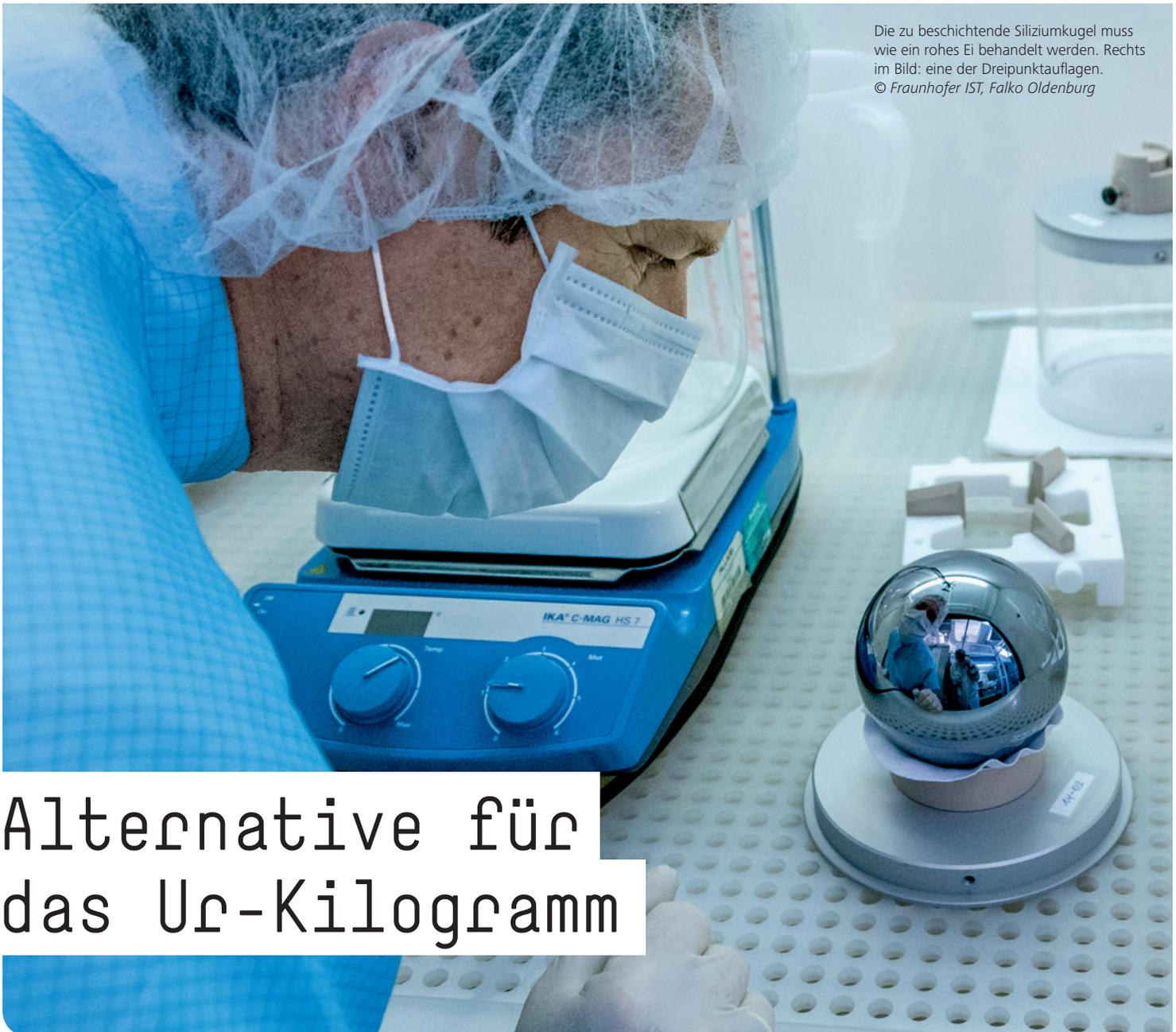
Die zu beschichtende Siliziumkugel muss wie ein rohes Ei behandelt werden. Rechts im Bild: eine der Dreipunktauflagen.
