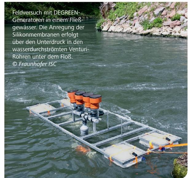
Feldversuch mit DEGREEEN-Generatoren in einem Fließgewässer. Die Anregung der Silikonmembranen erfolgt über den Unterdruck in den wasserdurchströmten Venturi-Rohren unter dem Floß.
