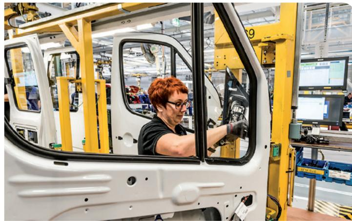
Vernetzte Technologien sorgen für mehr Prozesssicherheit in der Fertigung. In einer Pilotphase wurden zunächst Seitenspiegel und Sitze mit RFID-Tags ausgestattet. © Fraunhofer IFF, Andreas Süß
