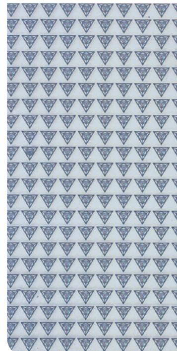
Der »Auxetic Cube« ist so strukturiert, dass er auf unterschiedliche Belastungen intelligent reagiert. Bei leichtem Druck gibt er nach, ab einer bestimmten Stärke bleibt er steif.
