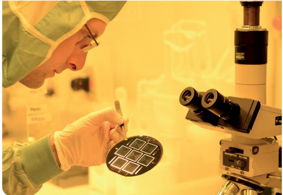
Beidseitig kontaktierte Siliziumsolarzelle mit TOPCon-Technologie, 25,1 Prozent Weltrekord-Wirkungsgrad. © Fraunhofer ISE
