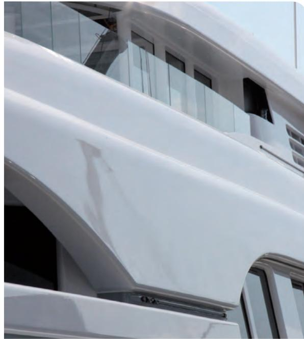
Ein dünner Auftrag von Spachtelmasse gepaart mit der Forderung nach ebenen und kontinuierlichen Oberflächen sind die Zielsetzungen bei der Oberflächenbeschichtung von Yachten. © Firma Lürssen Werft
