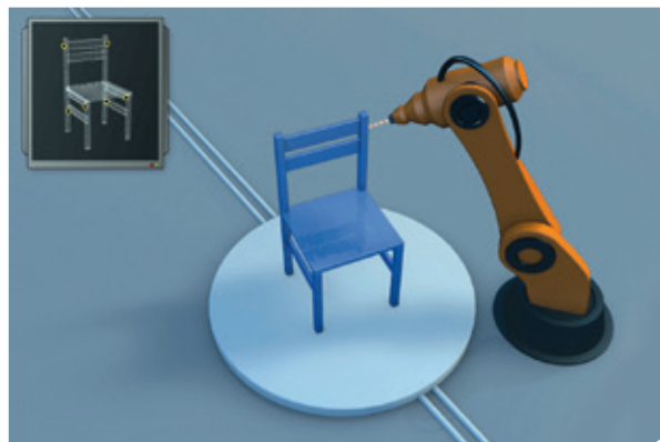
Schematische Darstellung der Berechnung und des Messprozesses am Beispiel eines Stuhls. Lackierprozess (links), Schichtdickenmessung (rechts). © Fraunhofer ITWM
