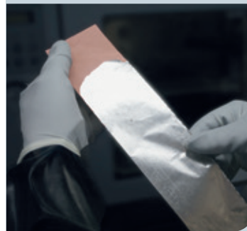
20 μm dünner Lithium-Film auf vorbehandelter Kupferfolie. © Fraunhofer IWS
