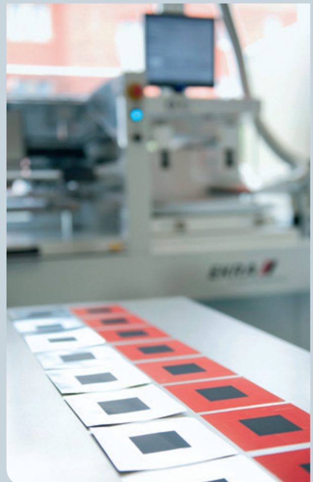
20 μm dünner Lithium-Film auf vorbehandelter Kupferfolie. © Fraunhofer IWS
