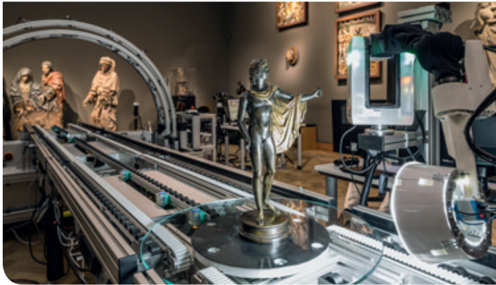
Der »Apoll vom Belvedere« wird im Mittelaltersaal der Liebieghaus Skulpturensammlung in Frankfurt am Main vom mobilen Digitalisierungslabor CultLab3D des Fraunhofer IGD gescannt. © Liebieghaus Skulpturensammlung
