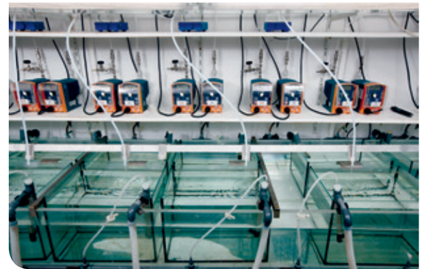
In der Durchflussanlage werden kontinuierlich Substanzen dem Wasser zugefügt.
